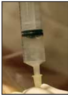
Figure 10 - Des pulsions intermittentes sont effectuées sur le piston. Après chaque pulsion, le liquide porteur de cristaux est recueilli sous la forme d'un nuage blanc.
